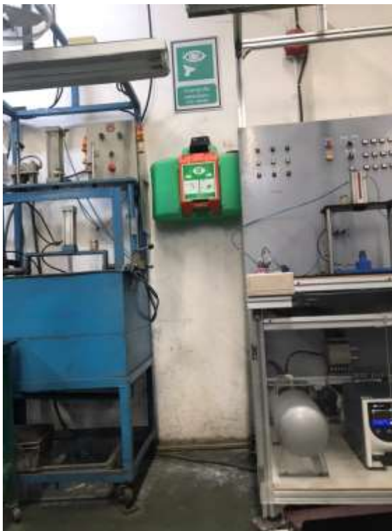
รูปภาพอุปกรณ์ชำระล้างตาฉุกเฉินแบบเคลื่อนที่ได้ บริเวณแผนกเครื่องมือกล
