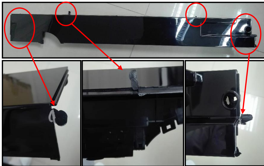
ภาพที่ 3.5 ชิ้นงานเกิดครีบบนตัว (Bari)
