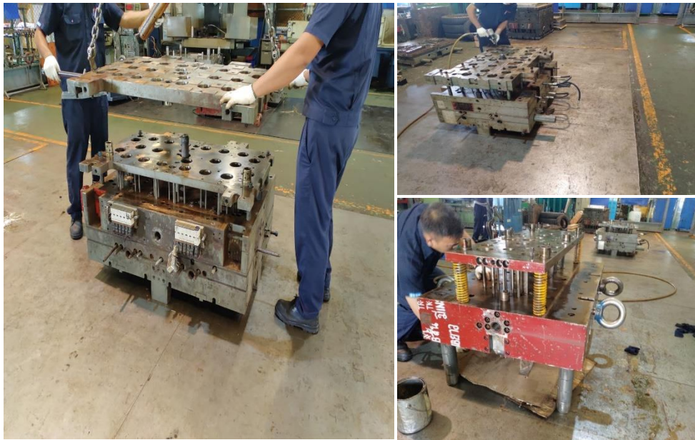
ภาพที่ 3.9 แผนก MOLD SHOP ทำการซ่อมแม่พิมพ์
