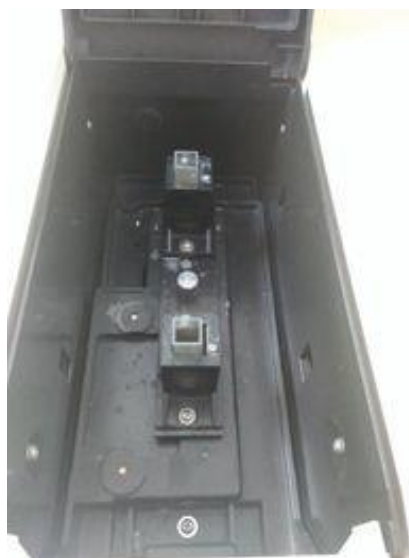
ภาพที่ ผ.ค 2 ปรับความเข้มข้นของเชื้อด้วยเครื่อง spectrophotometer ที่ความยาวคลื่น 600 นาโนเมตร ให้ค่าการดูดกลืนแสงที่ได้อยู่ในช่วง 0.5
