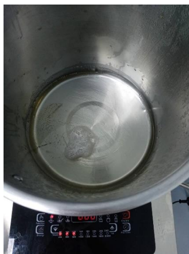
ภาพที่ ผ.ง 2 ละลายเบสสบู่ให้เป็นเนื้อเดียวกัน
