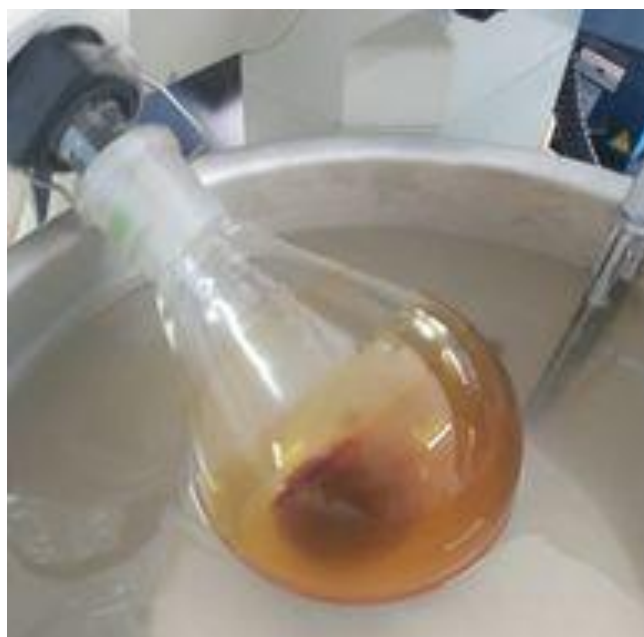
ภาพที่ ผ.ข 2 การระเหยสารสกัดให้แห้งด้วยเครื่องRotary vacuum evaporator
