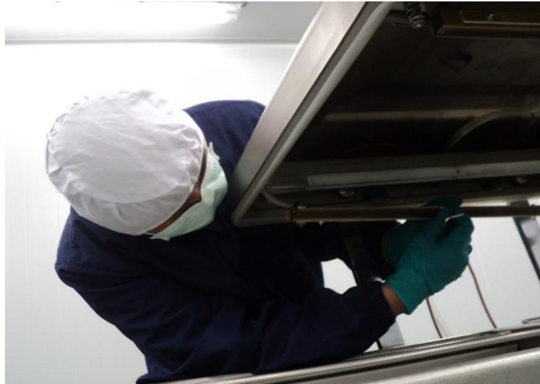
รูปภาพ ภาคผนวก ค.15 ชั้นน็อตสปริงออกจากแท่นฮีตเตอร์
