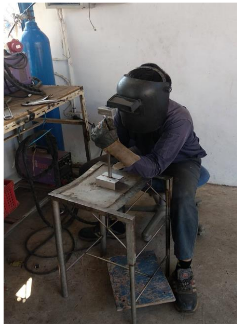
รูปภาพ ภาคผนวก ชั้นตอน ค.6 นำชิ้นงานมาเชื่อมในใส่เป็นอุปกรณ์ที่วางเทอร์โมมิเตอร์
