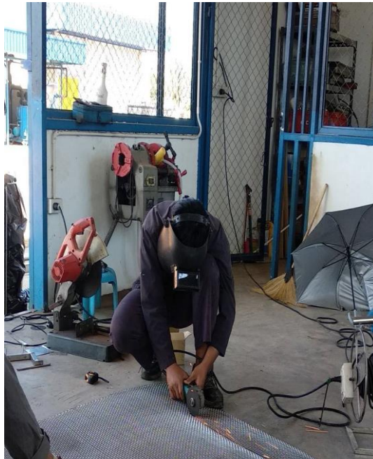
รูปภาพ ภาคผนวก ค.11 ตัดตะแกรงอย่างด้วยเครื่องเจียร์
