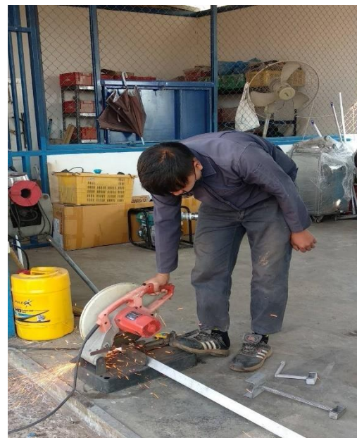
รูปภาพ ภาคผนวก ชั้นตอน ค.2 ตัดสแตนเลสตามขนาดที่วัด
