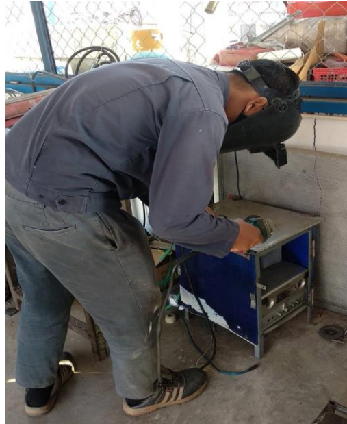
รูปภาพ ภาคผนวก ชั้นตอน ค.3 นำสแตนเลสมาเจียรลบความคม
