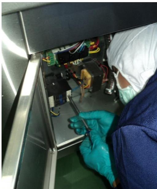
รูปภาพ ภาคผนวก ค.18 ต่อสายไฟใส่ปัมเครื่องสูญญากาศ
