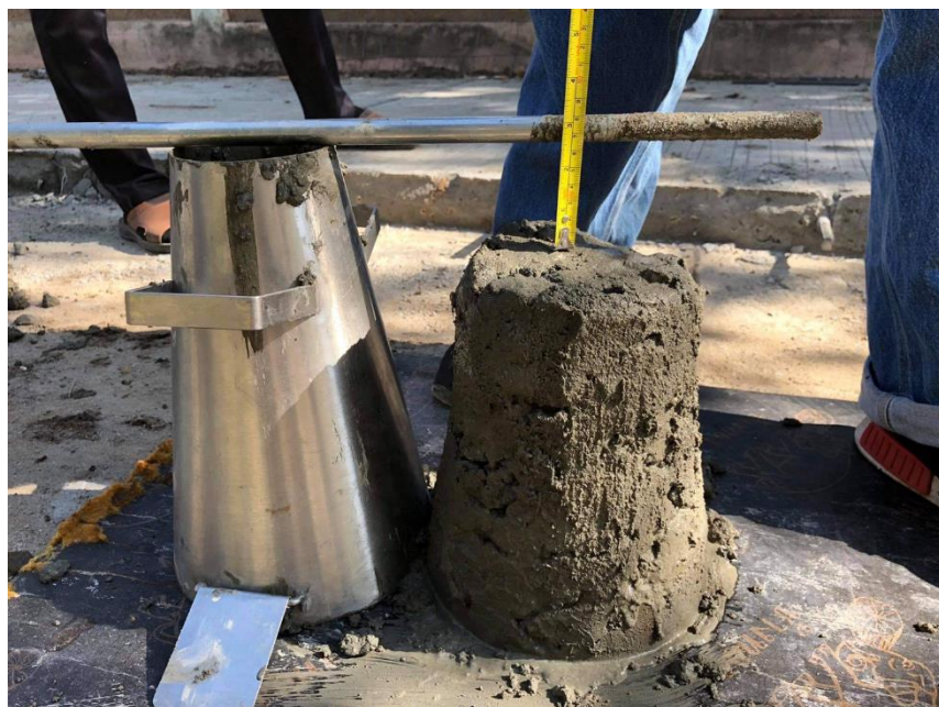
ภาพที่ 3.7 เช็ค Slump Test
