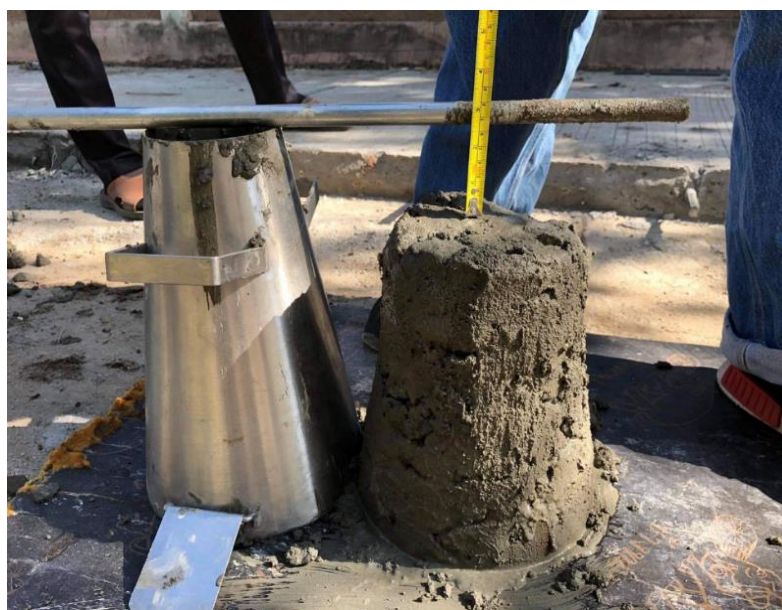
ภาพที่ 4.2 Slump Test
