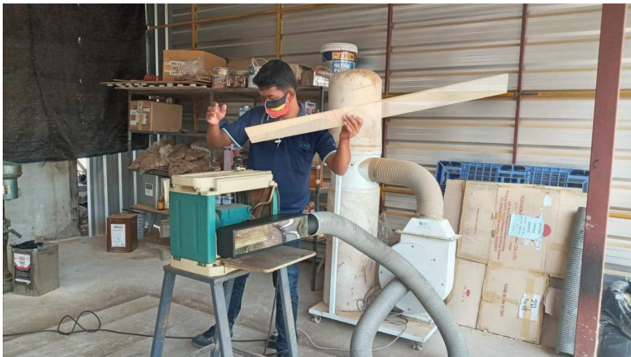
ภาพที่ 2-3 หลังการนำฝากรอบดักฝุ่นไปติดตั้งใช้งาน
