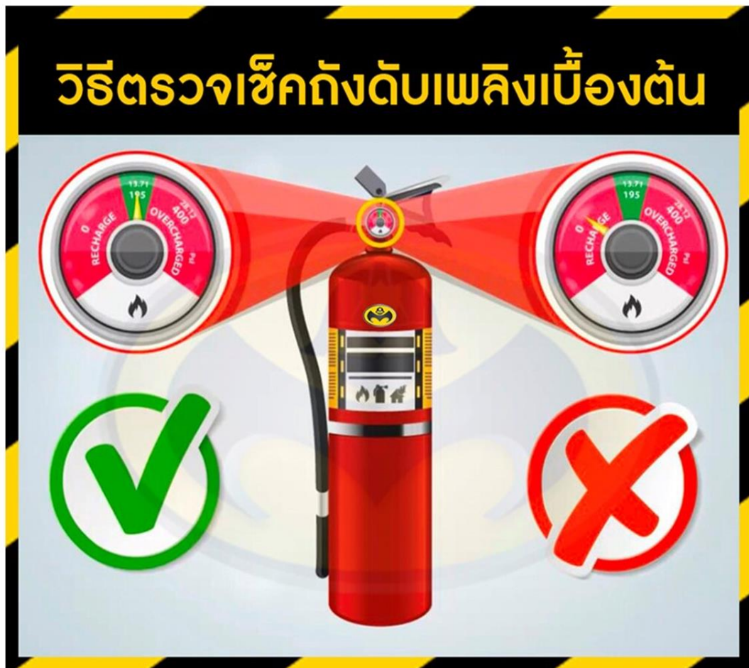
ภาพที่ 9 แสดงวิธีตรวจเช็คถังดับเพลิง
