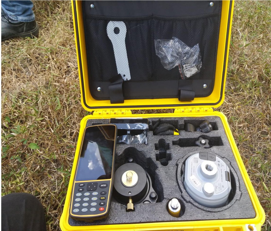
ภาพที่ ก.9 ชุดเครื่องมือเครื่องรับสัญญาณดาวเทียม
