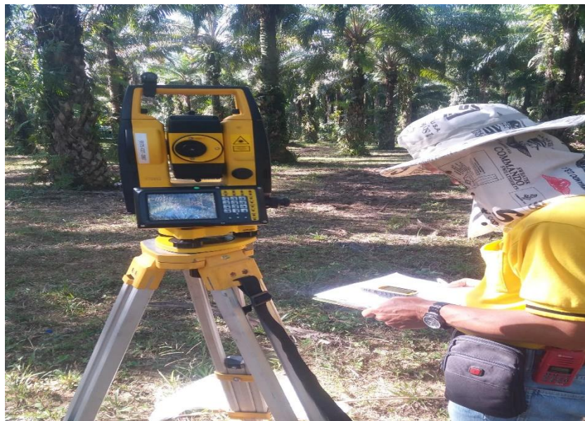
ภาพที่ 4.9 ระหว่างการปฏิบัติงานรังวัดโดยใช้กล้อง Total Station
