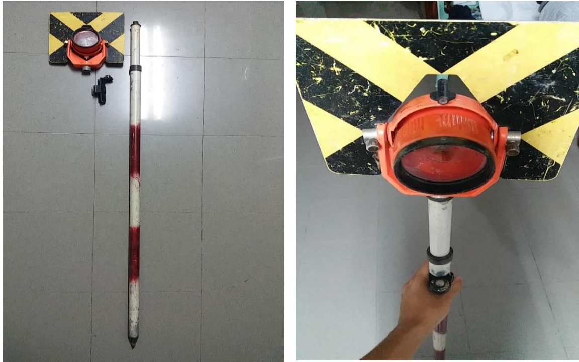
ภาพที่ 2.8 ชุดเป้าปริซึมสะท้อนแสงชนิดติดโพลพร้อมโพลสไลด์
