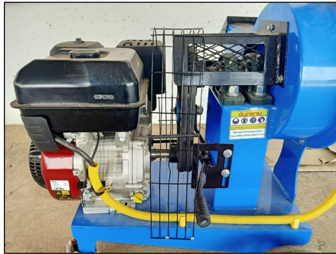
ภาพที่ 1-16 การติดตั้งการ์ดครอบสายพาน
