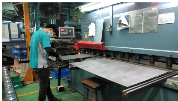
ภาพที่ 3.3 แสดงภาพการตัด ซอยแผ่นโลหะ
