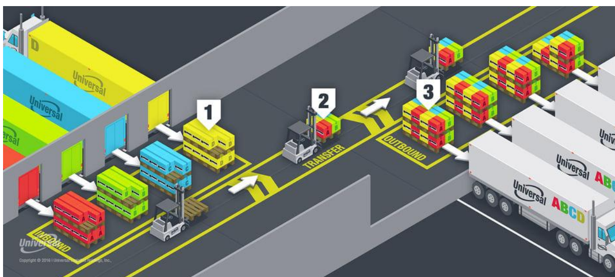
ภาพที่ 2.1 แสดงตัวอย่างแผนผังพื้นที่คลังสินค้าแบบ Cross dock ที่มี 3 ขั้นตอนคือ รับ รวม-คัดแยก และจัดส่ง ที่มาภาพ: Cross-DockingProcess. https://www.universallogistics.com/logistics/crossdocking/cross-docking-process/ . 2559.สืบค้นเมื่อ 1/12/2564
