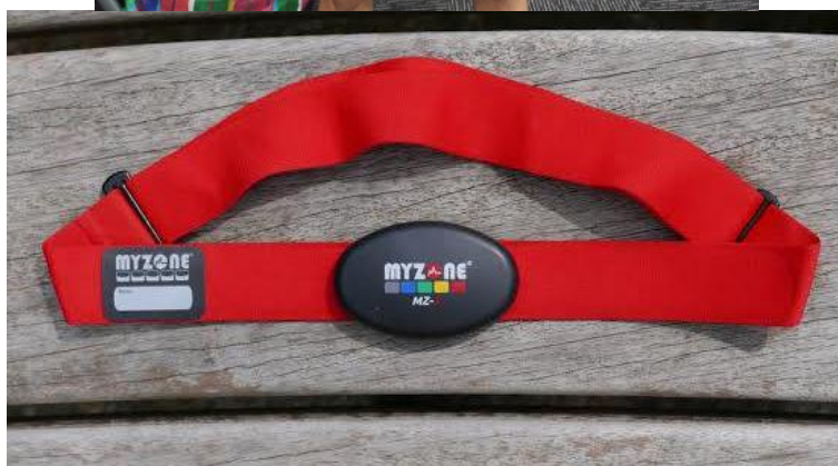
ภาพประกอบ 11 เซ็นเซอร์วัดอัตราการเต้นของหัวใจเนกประสงค์
