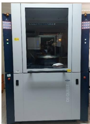
รูปที่ 3.2 เครื่องทดสอบการเลี้ยวเบนของรังสีเอ็กซ์ผ่านผลึกเดี่ยว (Single-Crystal X-ray diffraction; SC-XRD)
