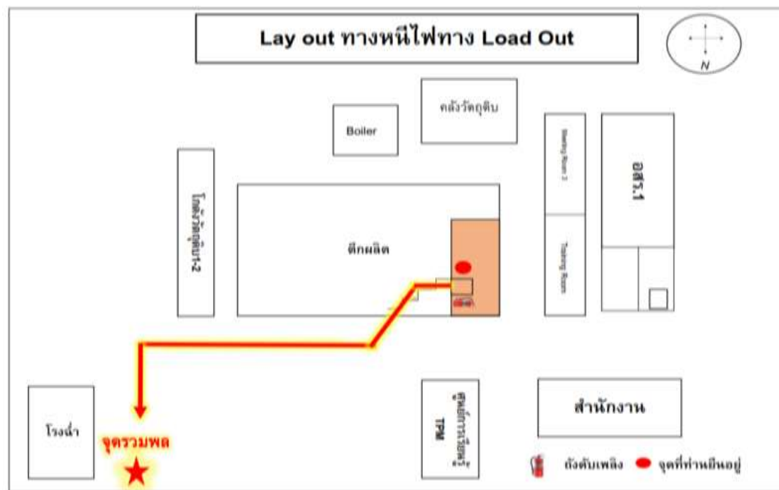
ภาพที่ 1-9 ทางหนีไฟทาง Load Out
