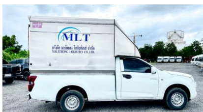
ภาพที่ 1.2 รูปรถตู้ทึบ อลูมิเนียม เปิดท้าย
