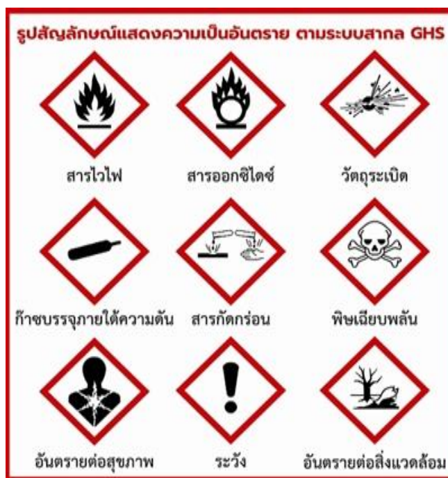
ภาพที่ 5 สัญลักษณ์แสดงความเป็นอันตราย ตามระบบ GHS
