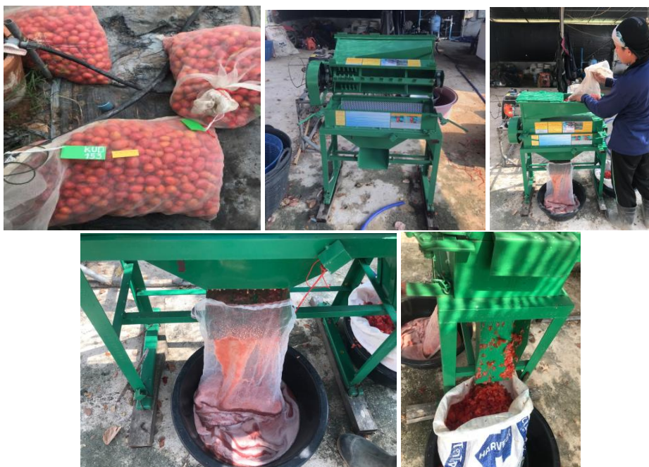
ภาพที่ 32 การสกัดเมล็ดโดยใช้เครื่องจักร
