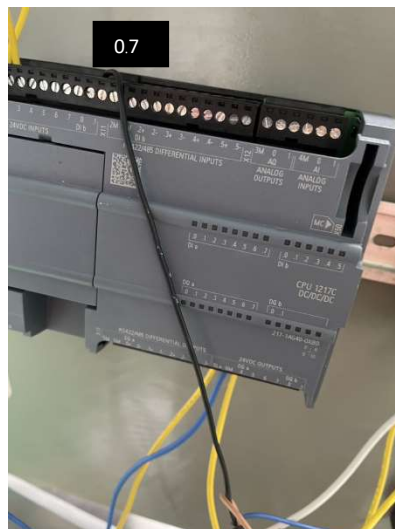
รูป 4.5.2 A สายสัญญาณจาก Inductive proximity sensor ไปยัง Digital input ของ CPU
