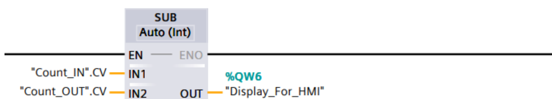
ภาพที่ 3.5 แสดงการทำงานของโปรแกรมโดยการนำค่าตัวแปร Count_IN ลบค่าตัวแปร Count_OUT
