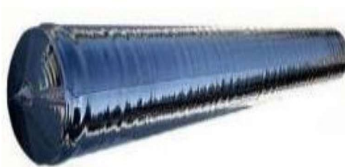
รูปที่ 2.8 ผลึกเดี่ยวของซิลิกอนบริสุทธิ์
